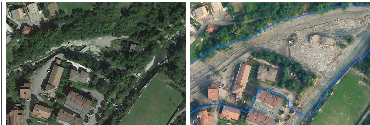
Figura 32: vista dall'alto della confluenza tra Rio Grondana e T. Nure immediatamente a valle dell'abitato di Ferriere prima dell'alluvione ( a sinistra) e dopo(a destra): dopo l'alluvione si nota il depuratore fognario danneggiato e la asportazione di una notevole estensione di vegetazione.
