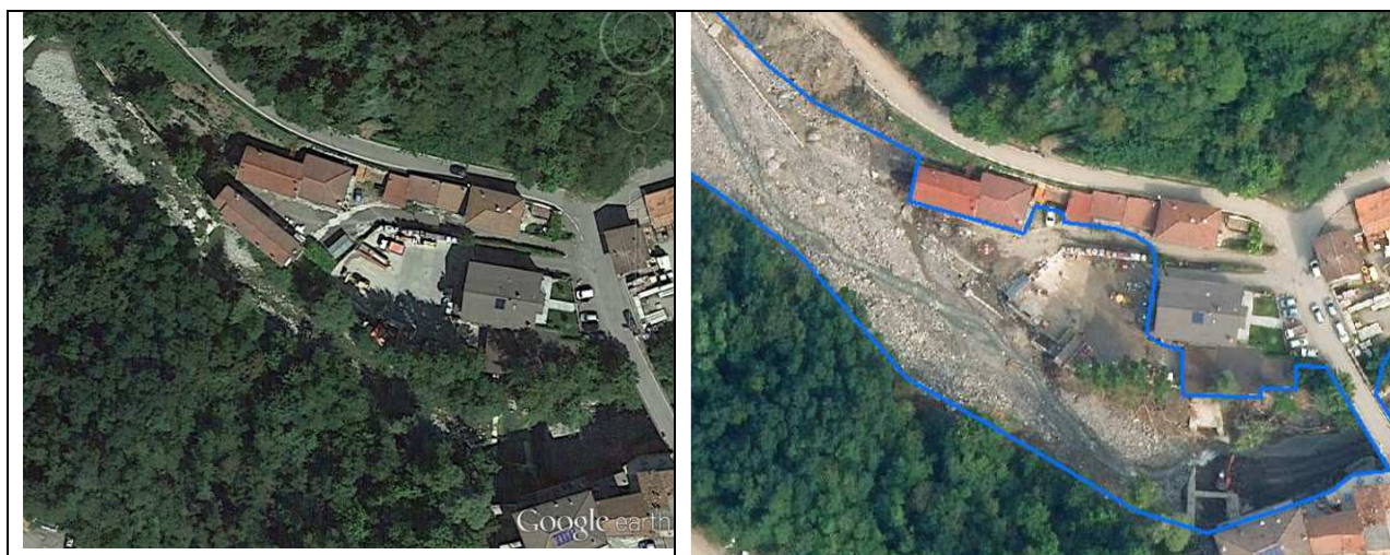
Figura 31: vista dall'alto del Rio Grondana dentro l'abitato di Ferriere prima dell'alluvione ( a sinistra) e dopo(a destra): dopo l'alluvione si nota la scomparsa di un edificio e la asportazione di una notevole estensione di vegetazione (in blu il limite dell'area allagata).
