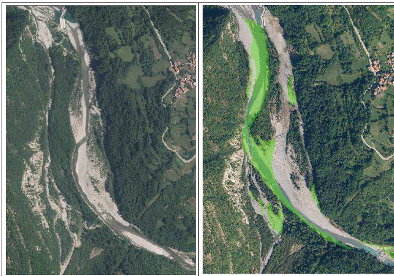
Figura 42: Esempio di asportazione massiva di materiale vegetale dall'alveo lungo il T. Trebbia in Comune di Ottone. A sinistra la situazione precedente la piena e a destra la situazione successiva. In verde l'area denudata.
